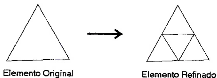
Figura 6.2 – Esquema de refinamento hanging node para elemento triangular.
