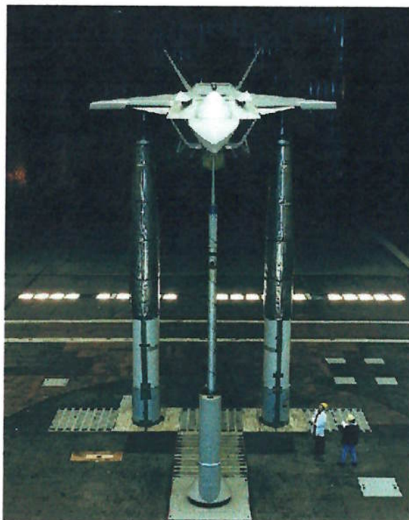
Figura 7.27 – Ensaio em túnel de vento utilizando suporte na configuração 2.
