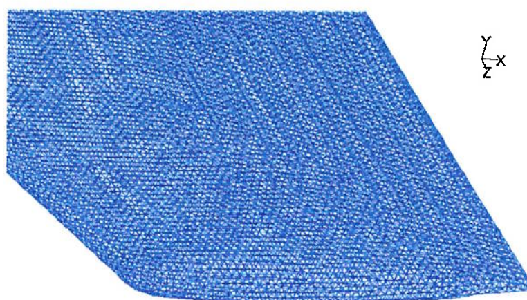
Figura 7.4 - Detalhe da malha na ponta da asa.
