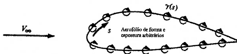
Figura 3.8 - Substituição da superfície de um aerofólio por uma cortina de vórtices
